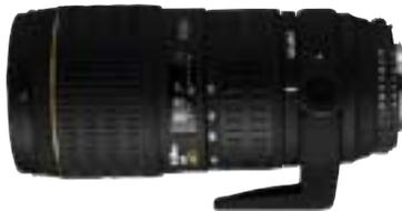
Telezoom extraluminoso di apertura f/2.8 su tutte le focali. Utilizza due speciali lenti in vetro ottico a bassa dispersione SLD nel gruppo anteriore e due in quello posteriore. Il sistema HSM garantisce la messa a fuoco automatica silenziosa e veloce. La messa a fuoco non modifica la lunghezza dell'obiettivo e permette di tenere ben salda la fotocamera durante lo scatto. La messa a fuoco ad alta velocità è possibile anche con il teleconverter, acquistabile separatamente, 1,4X e 2X APO TELE.
