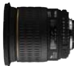
Obiettivo grandangolare da 20 mm di focale. Ha un angolo di ripresa di ben  $94,5^\circ$  e una apertura massima di  $f/1,8$ . Permette di scattare fotografie a distanza ravvicinata fino a 6,5 cm. La distorsione è compensata con l'uso di lenti asferiche. Ha una ridottissima caduta di luce ai bordi e grande luminosità anche negli angoli della inquadratura. Il sistema di messa a fuoco interna elimina la rotazione del barilotto anteriore e consente un uso ottimale del paraluce.
